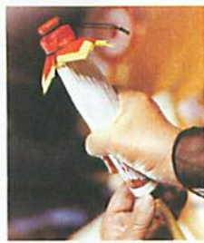
傘をたたまみ、頭のロクロ口部分に【カッパ】と呼ばれる飾り糊紙を付けて糸で縛れば完成です。
