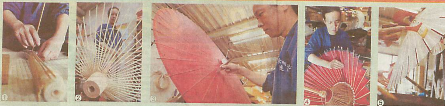
①「ろくろ」という木製部品に、竹製の骨を一本一本、糸でつないで固定していく ②和紙を張り付ける親骨48本に、それを支える48本の小骨を糸でつなぎ、開閉できる状態に ③先の割れた和傘作り独特の道具、またペグを使い、竹骨を扶むようにつけて和紙を押しこめていく ④少しづつ傘を開きながら、竹骨と竹骨との間に何度も指を滑り込ませて折り畳んでいく ⑤防水が必要な和傘には油引きの作業。時間とともに和紙はじわじわと浸透するため、塗り加減はとても難しい
