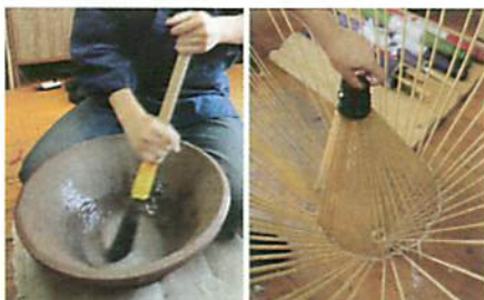
椀に使うタビオカを野球バットで混ぜる。幾何学的に美しい和傘の構造。この後、和紙を貼る。
