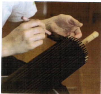
顔料を塗る作業。カシュー、漆など傘の種類によって使い分けられる。
